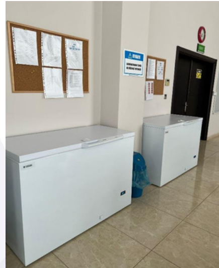
DERİN DONDURUCU UĞUR / USD 3045 BK Sıcaklık aralığı: -40.....-45 °C İç boyutları: 1120x440x705 mm
