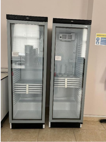
DİJİTAL ŞİŞE SOĞUTUCU UĞUR / USS 374 DTKE Sıcaklık aralığı: +1.....+10 °C Bürüt hacim: 358 L İç boyutları: 505x462x1555 mm Raf adedi: 5
